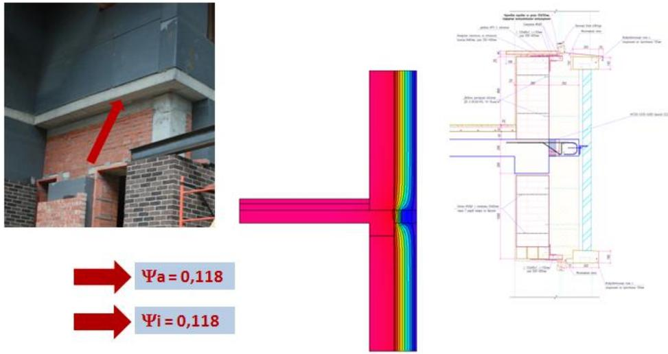
Рис. 16. Примыкание ж/б консоли к наружной стене через несущий теплоизоляционный элемент в зоне межэтажного перекрытия.
