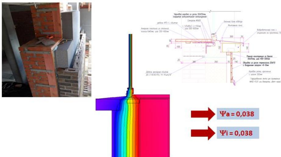
Рис. 15. Прямыкание оконного блока.
